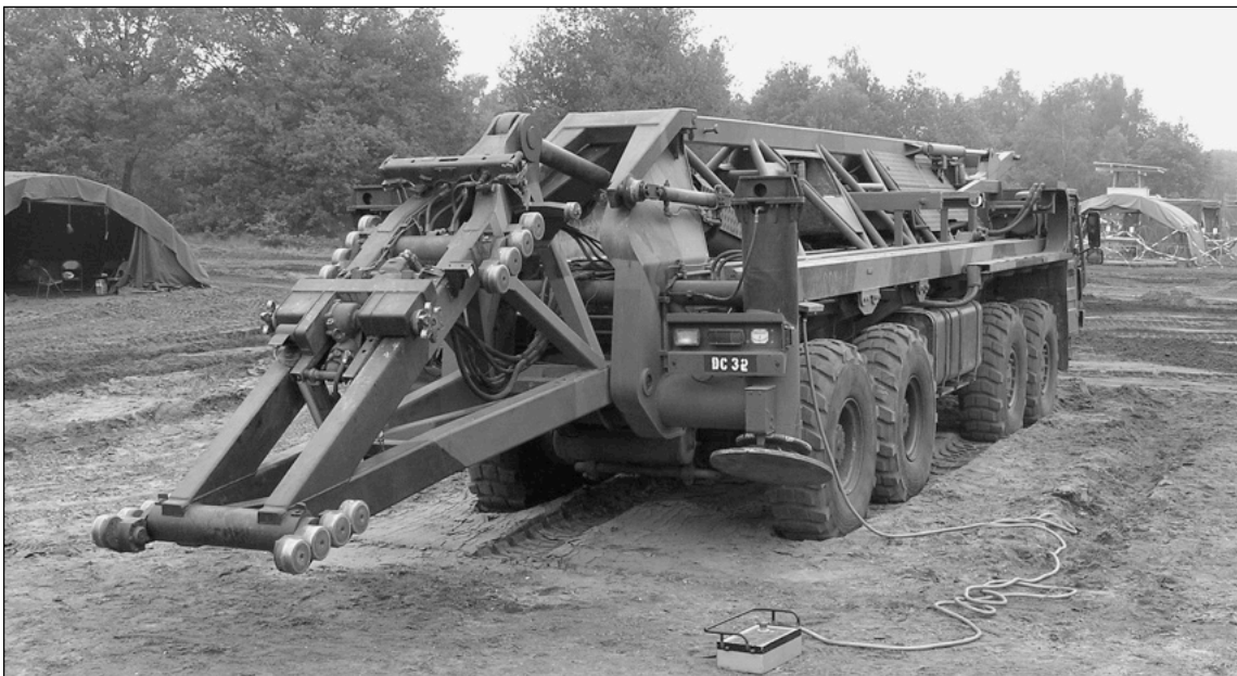
M.A.N. met Leguan brugsysteem. De KL leest vier van deze voertuigen van het Noorse leger. De brug kan 25 meter overspannen en heeft een draagvermogen voor voertuigen tot 70 ton (foto's Wim den Dunnen)
